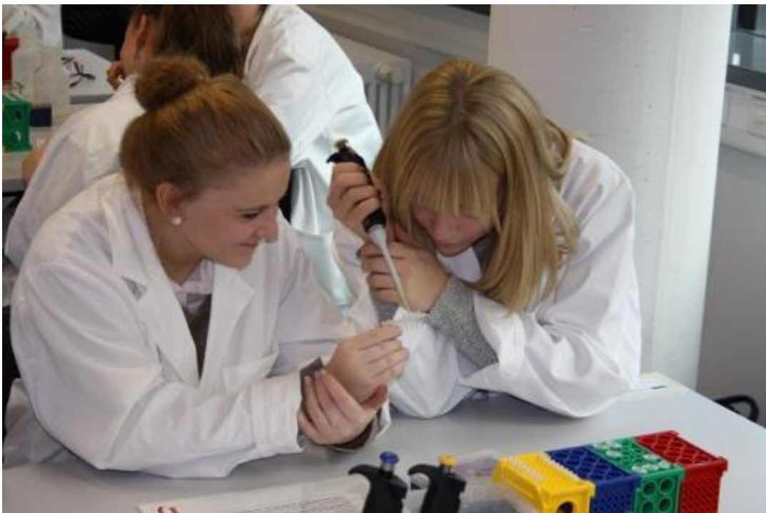
Abbildung 5: Schülerinnen pipettieren im teutolab -biotechnologie den Reaktionsmix für die PCR zusammen
