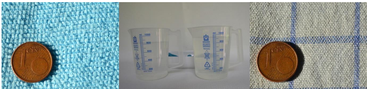
Abb. 2: Material und Ergebnis beim „Handtuchversuch“ (Station 2). Verbliebenes Wasservolumen beim Mikrofaserhandtuch (links): ca. 820 mL, verbliebenes Wasservolumen beim Leinenhandtuch (rechts): ca. 920 mL; exemplarische Werte aus eigenen Experimenten. Fotos: U. Baumann-Groten.
