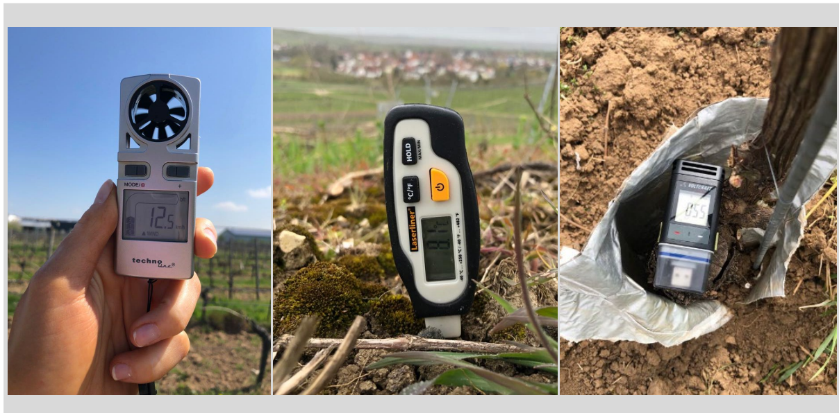
Abbildung 4: Geräte zur Messung der Umweltfaktoren. Von links nach rechts: Technoline Sensor Windmesser (Wind und Lufttemperatur), Laserliner-Thermometer (Bodentemperatur), Datenlogger Voltcraft DL-210 TH (Lufttemperatur). Fotos: R. Schiffmann
